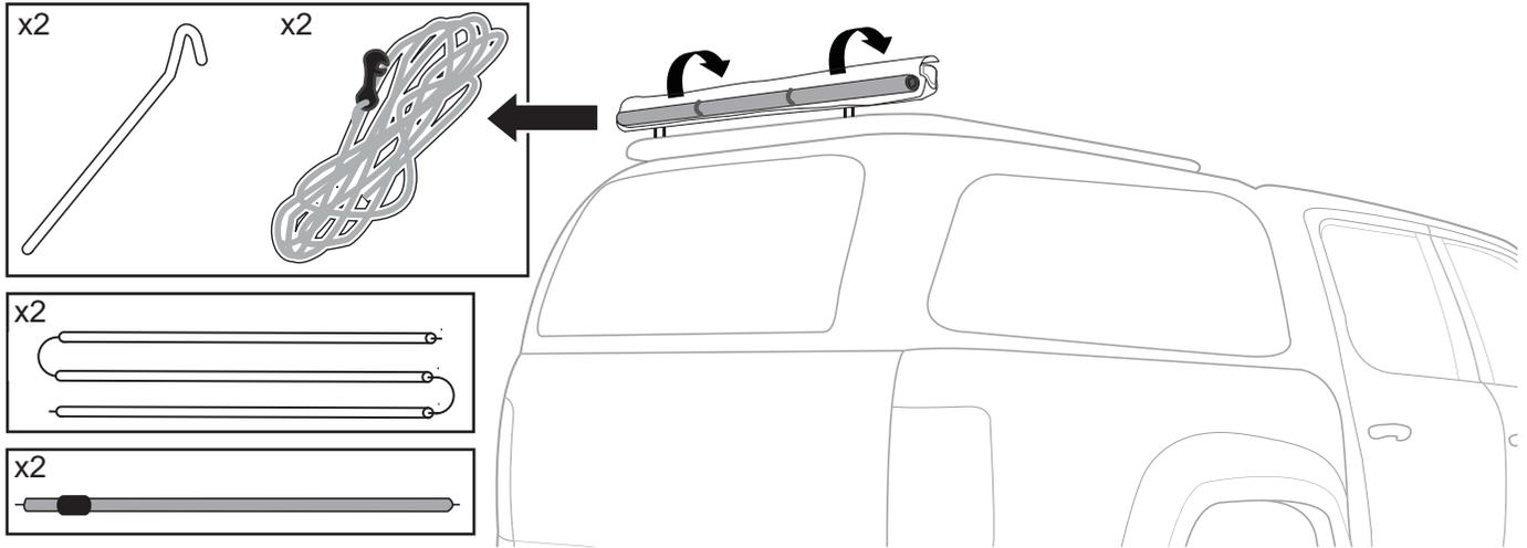
**6** Öffnen Sie die Klettverschlüsse (A) und (B) und rollen Sie die Markise aus, wie gezeigt.
