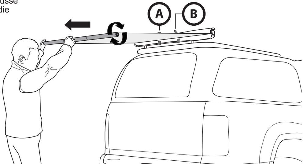
**7a** Schwenken Sie die beiden Hilfsstangen nach außen.
