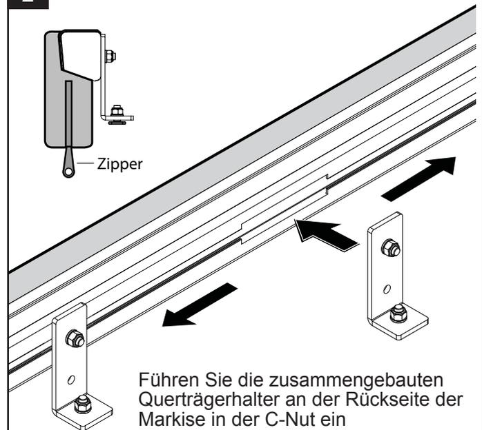
Führen Sie die zusammengebauten Querträgerhalter an der Rückseite der Markise in der C-Nut ein
