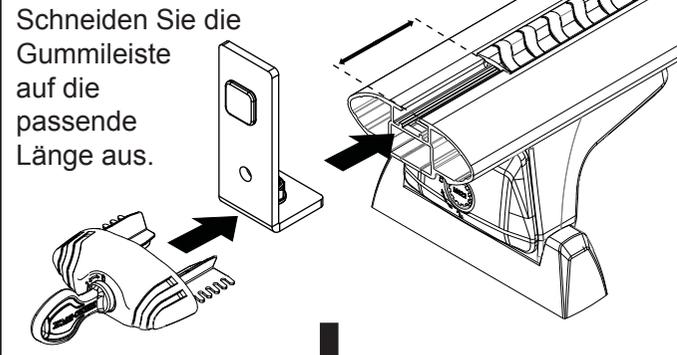
**3B** Schneiden Sie die Gummileiste auf die passende Länge aus.
